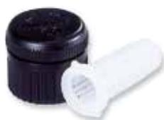
Irrigatori ad allagamento autocompensanti sono simili ai sopracitati getti separati, ma differiscono per la loro diversa conformazione ad ombrello nella distribuzione dell'acqua. Sono utilizzati in piccole aiuole fiorite o nelle siepi per non bagnare le foglie delle piante. I modelli PCB hanno la portata costante al variare della pressione e quindi possono funzionare contemporaneamente con gli irrigatori statici e dinamici a scomparsa.
