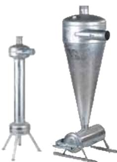
Filtro in acciaio zincato a caldo, separatore di solidi contenuti nell'acqua. La nuova tecnica di funzionamento e di costruzione del filtro, consente anche in condizioni estreme, di filtrare il 99% dei solidi contenuti nei liquidi. Le portate indicate sono relative alla perdita di carico da 0,5 a 1 Bar. Per il funzionamento è necessaria una pressione all'ingresso di almeno 3 Bar.
