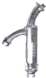
Filtro in acciaio zincato a caldo, utilizzato in impianti a goccia per filtrare l'acqua proveniente dal pozzo. Da installare come sistema di sicurezza dopo filtro a graniglia quarzite. Grazie al sistema di apertura a farfalla, non sono necessarie chiavi ed attrezzi per la manutenzione. Le portate indicate, sono relative alla perdita di carico 1 Bar.
