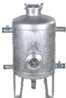
Filtro in acciaio zincato a caldo con sistema filtrante a quarzite (Ø 1-2mm). Utilizzato per togliere alghe, argilla e melma dall'acqua. Le portate indicate, sono relative alla perdita di carico 1 Bar.
